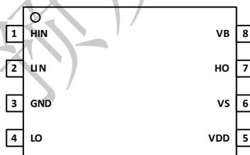
图 6-1 CA-IS3223EHS-Q1 引脚配置 SOIC8-NB
